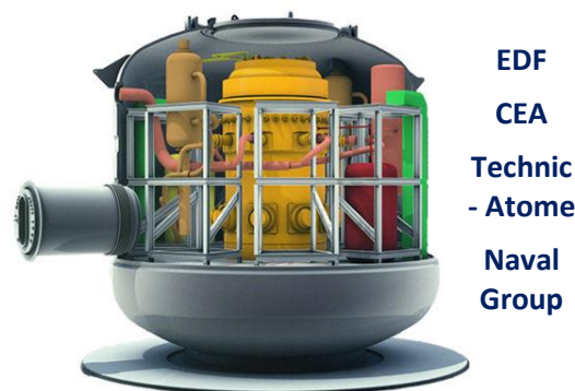
Concept français Nuward : cuve de sécurité contenant tous les composants primaires
